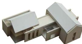
Der Schlafbereich der Eltern liegt im linken Gebäudeteil unter dem Satteldach. Im Modell fällt es unbedeutender aus. Der umfangende Quader wurde im Planungsverlauf verkleinert.
