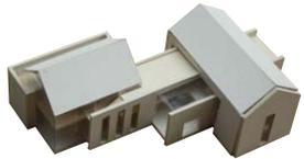
Das Modell verdeutlicht, wie die Baukörper einander durchdringen und auseinander herauswachsen. Das Elternhaus mit dem Satteldach (links) ist als Zusammenspiel zweier Quader erkennbar, das Dach fast leicht und fliegend.
