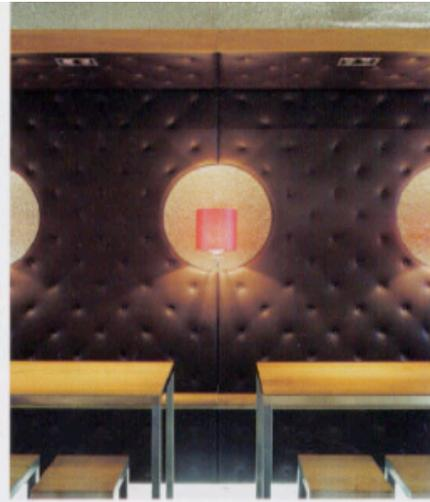
Die Lichtplanung bestimmt die Atmosphäre im Raum: – indirekt als Grundbeleuchtung – gerichtet mit Strahlern, aus dem Deckenelement über den Tischen oder als Wandbeleuchtung
